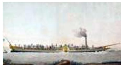
La machinerie était composée d'un cylindre horizontal à « double effet » de 20 CV (32 CV à toute vapeur). La transmission se faisait par une crémaillère dentée (comme sur le 1<sup>er</sup> vapeur de J. d'Albans sur la Saone en 1783). La chaudière était isolée par une couche d'argile. Les roues avaient un diamètre de 3,250 mm, les aubes faisaient 1,95 mm sur 650 mm, et l'ensemble tournait à 25 tours minutes (33 à toute vapeur).
