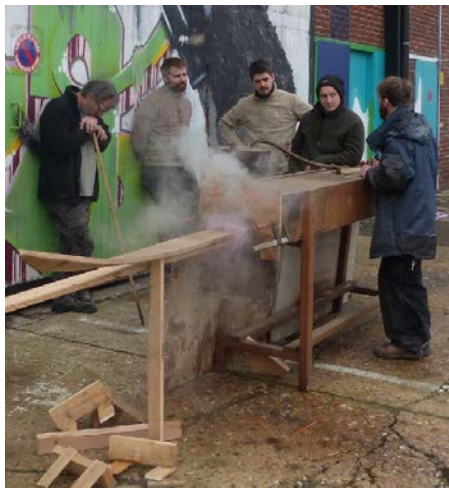
Opération d'étuvage avant cintrage d'une pièce de charpente
